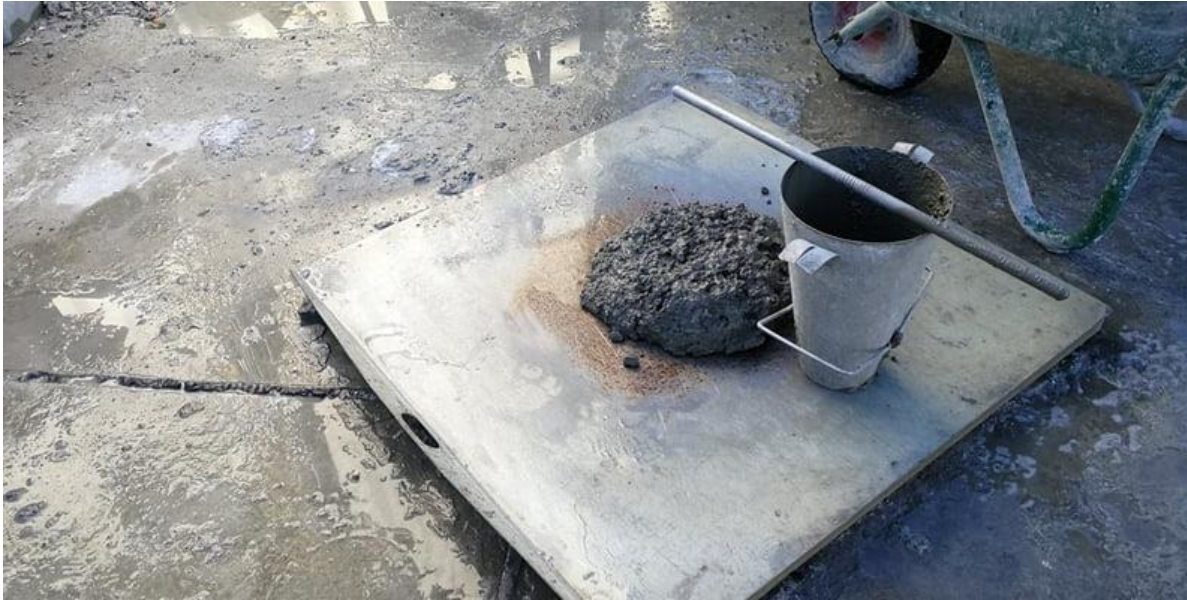
Abbildung 4 Slump-Kontrolle in der Betonmischanlage.
